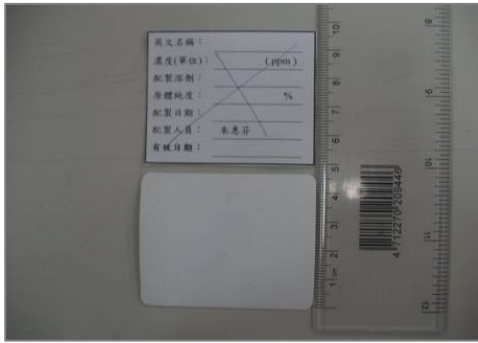
圖7. HF RFID 電子標籤(ISO 15693 52mm x 52 mm 規格)。
