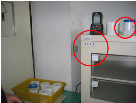
圖9. 檢樣及儲位貼上 HF RFID 電子標籤及一維條碼標籤。
