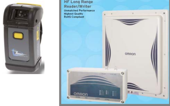
圖8. 左圖為 HF 手持讀寫器(ISO 15693規格，內建可讀取一維條碼功能)，右圖為 HF 固定式讀寫器(ISO 15693規格)。
