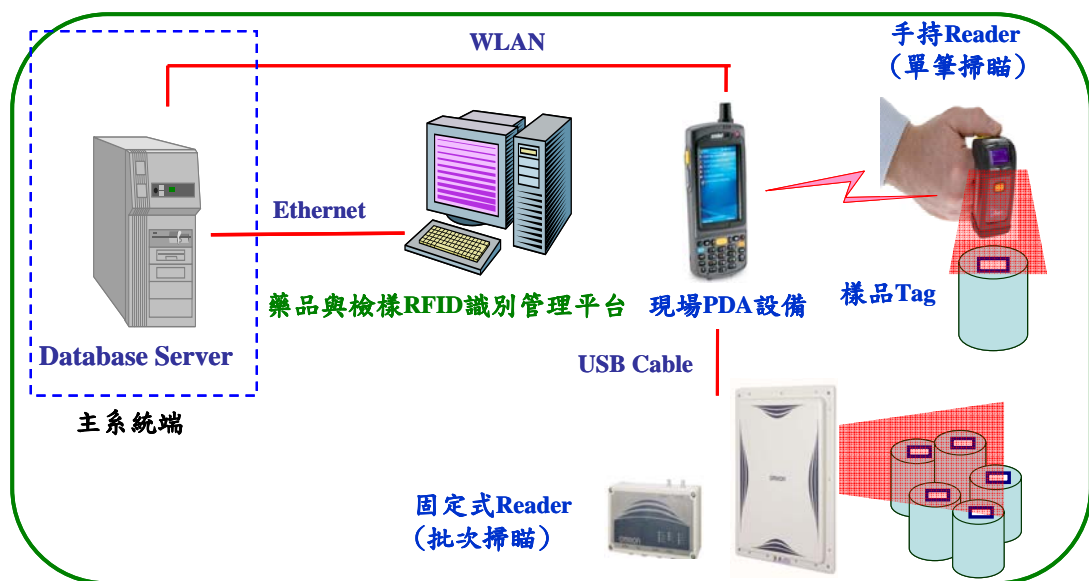
圖 6. RFID 在檢體與儲位管理平台系統架構。
