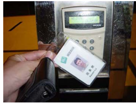
圖3. RFID 員工門禁結合出勤系統。
