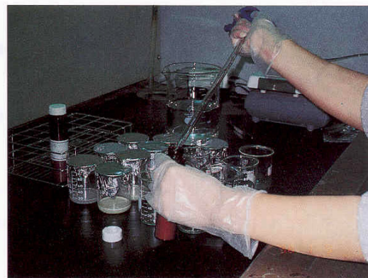
圖 10. 配製各種測試農藥之序列藥液。
