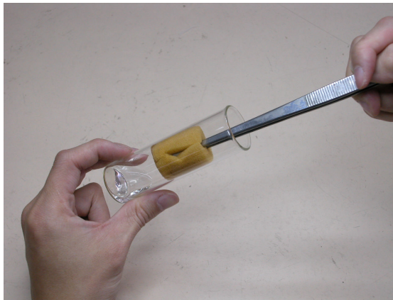
圖9. 指形瓶內墊入泡棉，防止蚜蟲掉落水中。
