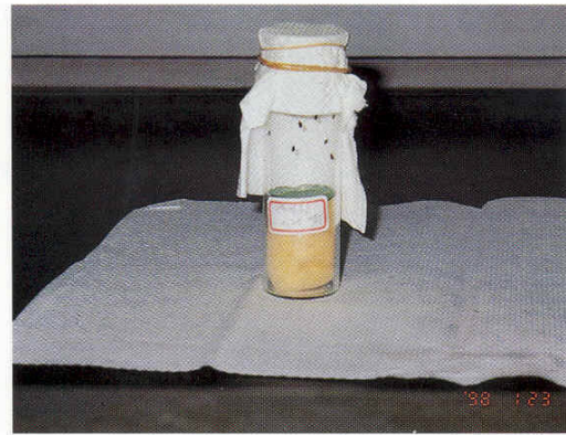
圖 17. 接蟲後利用紙巾將指形瓶封口，放入定溫箱中，定時取出觀察供試蟲死亡情形。
