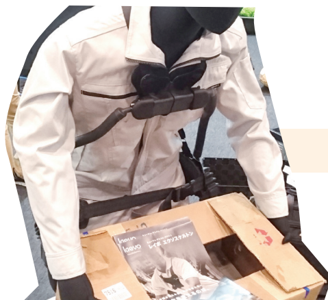
圖7. 機械外骨骼輔具。
